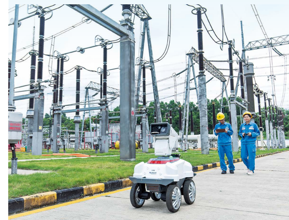
工作人员正在使用智能机器人开展巡视维护工作
